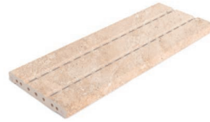
REJILLA DE DRENAJE RJ20 19,3x50x2.2 Desagüe >11m³/hora
